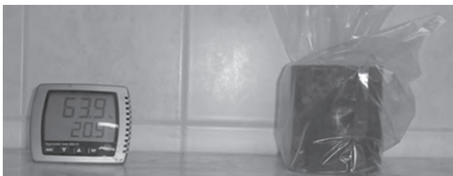
Obr. 7: Uložení tělesa v polyetylenovém sáčku v laboratorním prostředí
