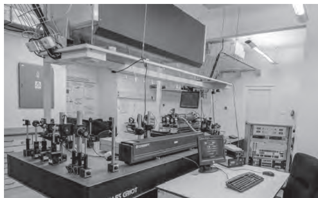
Pracoviště SE, součástí je kryogenní radiometr
