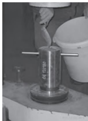
Obr. 3: Sypání zhomogenizované směsi do formy
